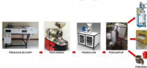
Gambar 2.1 Aliran Proses Produksi Kopi Sangrai dan Kopi Bubuk Secara Intergratif
